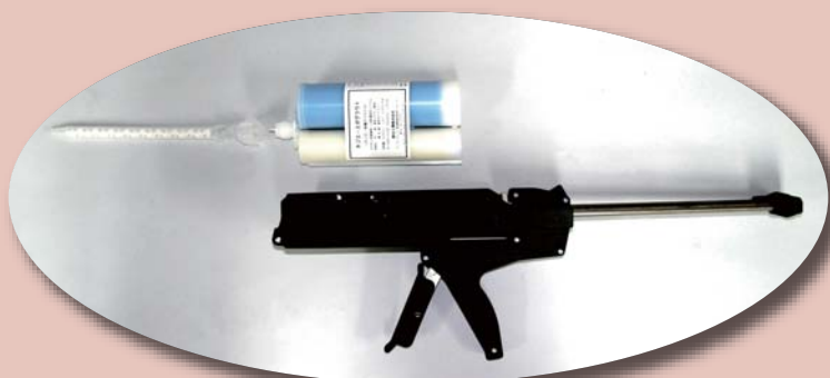
樹脂グラウト施工器具
