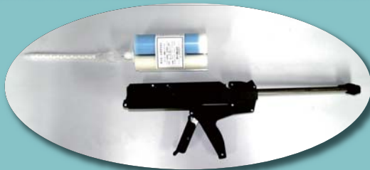
樹脂グラウト施工器具
