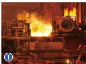
① 炉底出鋼式電気炉 (EAF)
