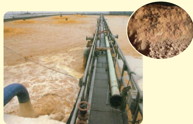
水産加工場の排水に含まれる魚たんぱく質を利用した有機肥料原料(右上)とその処理設備
