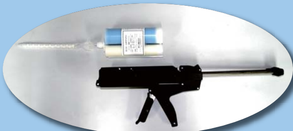
樹脂グラウト施工器具
