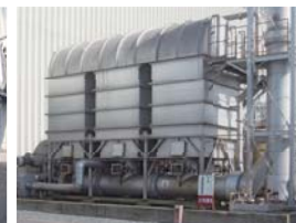
蓄熱脱臭設備
